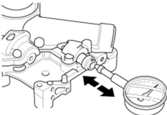
2. 顶住平衡轴的末端将百分表调零，然后来回地推动平衡轴并读取轴向间隙。
